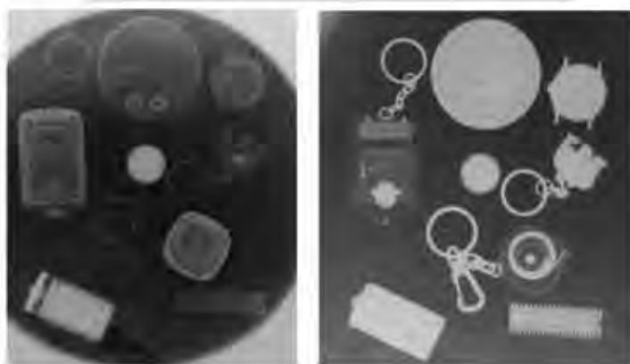
中性子透過写真(左)とX線写真(右)同じ物の写真
