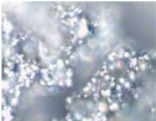
[F] NaOH 水溶液中での加熱後の亜鉛粉末(1500 倍)
